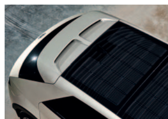
Das Solardach schafft eine Peakleistung von 205 Watt.
