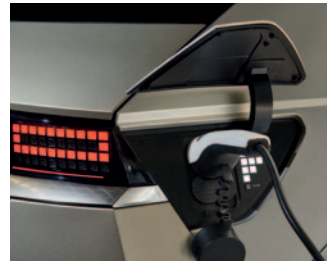
Laden wie beim Porsche Taycan: Der Ioniq 5 bedient sich der 800-Volt-Technologie.
