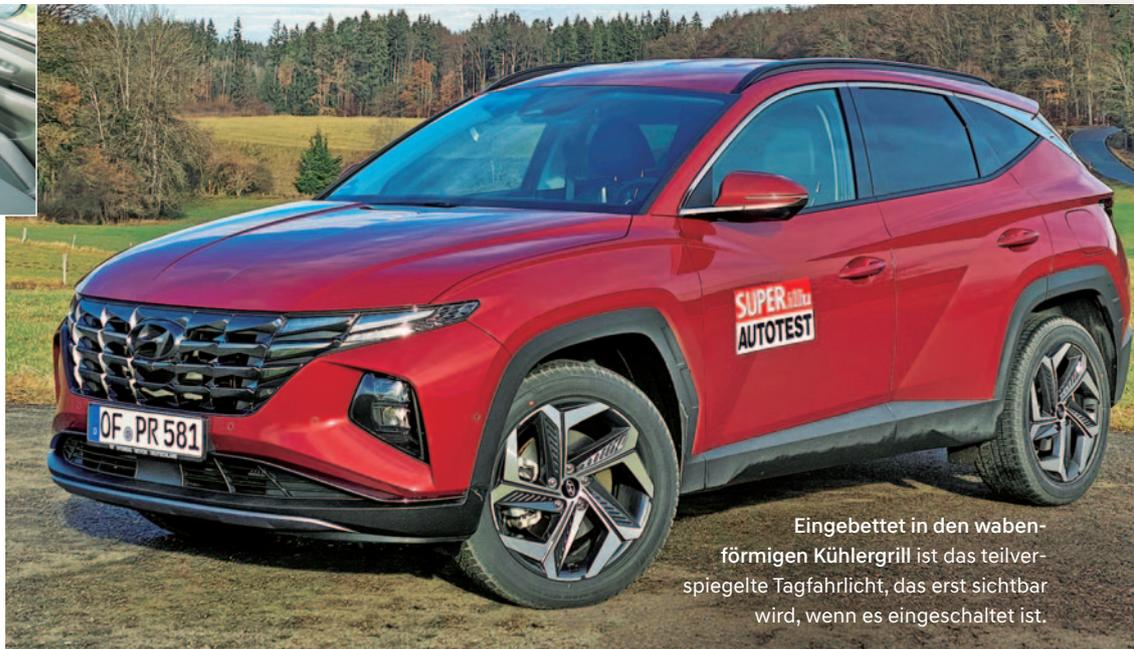
Eingebettet in den wabenförmigen Kühlergrill ist das teilverspiegelte Tagfahrlicht, das erst sichtbar wird, wenn es eingeschaltet ist.
