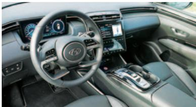
Volldigitales Cockpit, mit Smartphone-Anschluss. Monitor etwas tief. Extra-Panel für Heizung und Klima.
