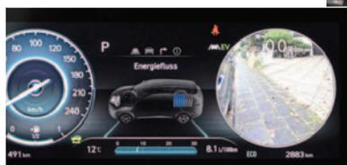
**Serienmäßige digitale Instrumente** im hochwertigen Cockpit, das ohne Armaturenhabe auskommt. 10,25-Zoll-Touchscreen auf der Mittelkonsole. **Top:** Der zuschaltende Totwinkelmonitor ergänzt den Seitenspiegel (o. links).
