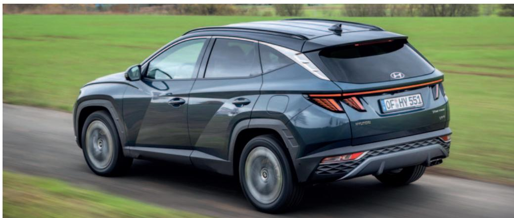
**Tucson-Heck:** Mit durchgehendem Leuchtenband und unter dem Dachspoiler versteckten Scheibenwischer.
