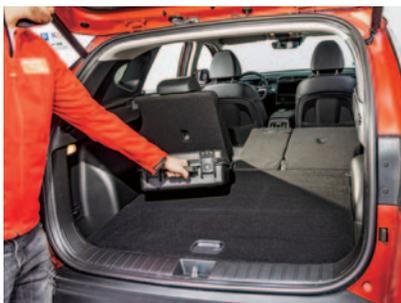
Dreiteilig klappbare Lehne, ebene Fläche, kleine Staufächer darunter.
