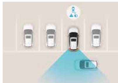
**Querverkehrswarner, hinten.<sup>1</sup>** Beim Zurücksetzen aus einem engen Parkplatz verringert der Querverkehrswarner das Risiko einer Kollision. Durch zwei Radarsensoren am Heck werden Sie im Falle von sich näherndem Querverkehr gewarnt.
