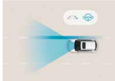
**Spurhalteassistent (LKA).** Der Spurhalteassistent überwacht mittels der vorderen Kamera die Fahrbahnmarkierungen. Sollte der Fahrer unbeabsichtigt die Spur wechseln, wird er gewarnt, und das Fahrzeug steuert gegen und lenkt zurück in die Spur, sofern Sie nicht selbst aktiv in eine andere Richtung lenken.
