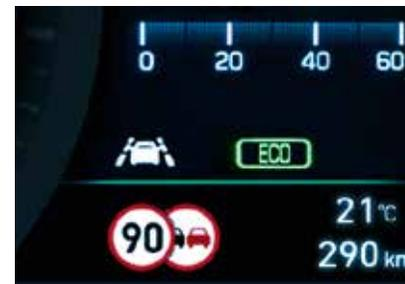
**Verkehrszeichenassistent.** Geschwindigkeitsbegrenzungen und Überholverbote werden über die Frontkamera erkannt und dem Fahrer über das Display in Echtzeit auf der Instrumentenanzeige und auf dem Navigationsdisplay angezeigt.
