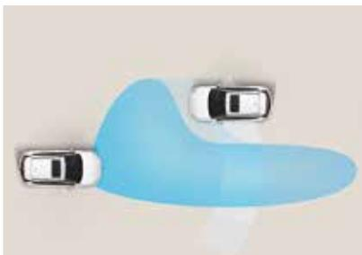
**Voll-LED-Lichttechnik.<sup>1</sup>** Der Fernlichtassistent entdeckt entgegenkommende Fahrzeuge sowie Fahrzeuge in derselben Fahrspur bei Nacht und schaltet automatisch von Fernlicht auf Abblendlicht. Das statische Kurvenlicht beleuchtet den seitlichen Bereich, wenn Sie in eine Kurve einbiegen, und verbessert so die Sicht bei Nacht.
