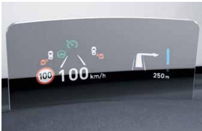
**Head-up-Display.<sup>1</sup>** Erhöhte Sicherheit im Blick. Wichtige Informationen wie Geschwindigkeit, Navigationsbefehle und Warnungen werden direkt auf Sichthöhe projiziert und sind dank ausgezeichneter Helligkeit leicht ablesbar.
