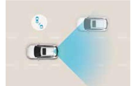
**Totwinkel-Assistent mit Spurwechselassistent.<sup>1</sup>** Zwei Radarsensoren überwachen den Verkehr im toten Winkel. Die Spurwechselhilfe gibt ein akustisches Alarmsignal, wenn bei Annäherung eines Fahrzeugs der Blinker gesetzt wird.
