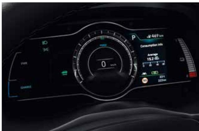
**7-Zoll-Instrumentencluster.** Das innovative 7-Zoll-Digitaldisplay zeigt dem Fahrer den gewählten Gang, den Energiefluss und den Batteriestand an. Wie Ihr Fahrstil die Reichweite beeinflusst, ist damit mit einem Blick erkennbar.
