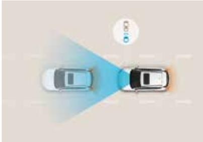
**Autonomer Notbremsassistent inklusive Frontkollisionswarner und Fußgängererkennung (FCA).<sup>1</sup>** Das FCA-System überwacht mit Kamera und Radarsensor den vorausfahrenden Verkehr. Stellt der Notbremsassistent fest, dass eine Gefährdung durch andere Fahrzeuge (8–180 km/h) oder für Fußgänger (bis 64 km/h) besteht, löst er zunächst eine optische und akustische Warnung aus und leitet im Notfall eine Teil- oder Vollbremsung ein, sofern Sie die Bremse nicht bereits selbst betätigt haben.
