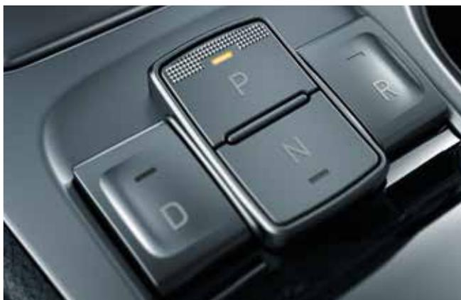
**Shift-by-Wire.** Die Gänge lassen sich im Hyundai KONA Elektro ganz einfach per Knopfdruck wechseln. Zusätzlich ist hier die elektrische Parkbremse untergebracht.
