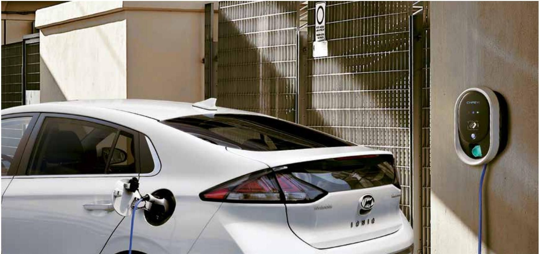
**Schnelles und flexibles Laden.** Je nach Ihrer Anbindung an das Stromnetz und Ihren Lademöglichkeiten bietet der Hyundai IONIQ Elektro Flexibilität beim Laden. Ein leistungsstarker, von 6,6 kW auf 7,2 kW verstärkter Wandler an Bord des Hyundai IONIQ Elektro, erlaubt schnelleres Laden an der Wallbox mit Hilfe von Wechselstrom. Bei Verwendung einer leistungsstarken Schnellladestation benötigt die Lithium-Ionen-Polymerbatterie nur 54 Minuten, um einen Ladestand von 80 % zu erreichen.
