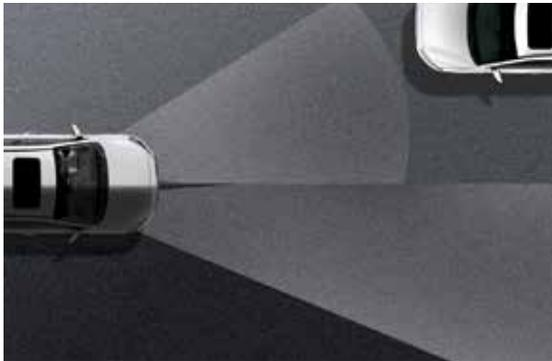
**Fernlichtassistent.** Der Fernlichtassistent entdeckt entgegenkommende Fahrzeuge sowie Fahrzeuge in derselben Fahrspur bei Nacht und schaltet automatisch von Fernlicht auf Abblendlicht. Das statische Kurvenlicht beleuchtet den seitlichen Bereich, wenn man in eine Kurve einbiegt, und verbessert so die Sicht bei Nacht.
