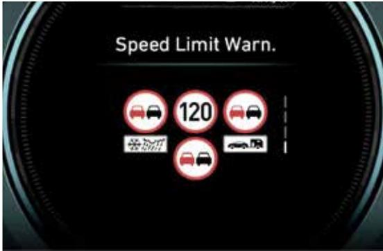
**Verkehrszeichenerkennung (ISLW).**<sup>1</sup> Die Verkehrszeichenerkennung nutzt eine im Bereich des Innenspiegels montierte Kamera sowie Navigationsdaten, um den Fahrer auf Geschwindigkeitsbegrenzungen und Überholverbote hinzuweisen.
