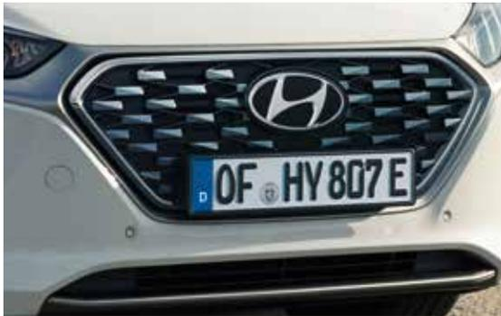
Der Grill des IONIQ Hybrid und Plug-in-Hybrid wurde aerodynamisch optimiert.
