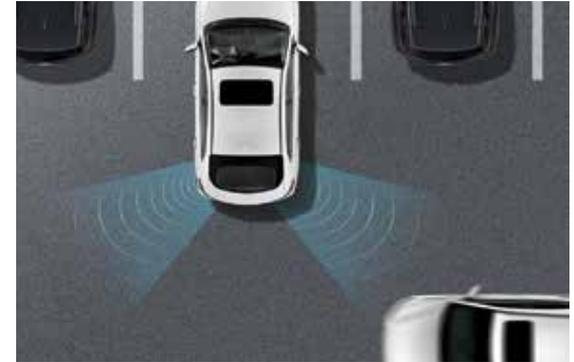
**Querverkehrswarner, hinten.**<sup>1</sup> Beim Zurücksetzen aus einem engen Parkplatz verringert der Querverkehrswarner das Risiko einer Kollision. Durch zwei Radarsensoren am Heck wird man im Falle von sich näherndem Querverkehr gewarnt.
