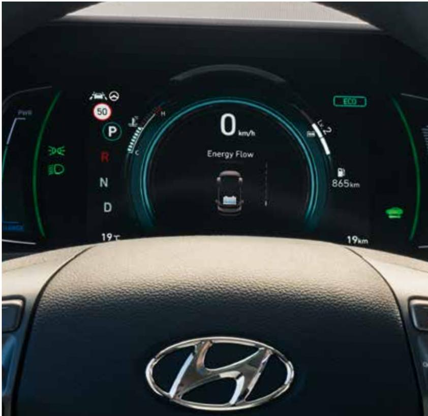
**Instrumentencluster.**<sup>3</sup> Das neue Instrumentencluster enthält einen 7-Zoll LCD-Bildschirm, der je nach Fahrmodus seine Hintergrundbeleuchtung ändert. Der Bildschirm zeigt eine Vielzahl an Informationen, wie Geschwindigkeit, aktueller Verbrauch und Batterieladung an.
