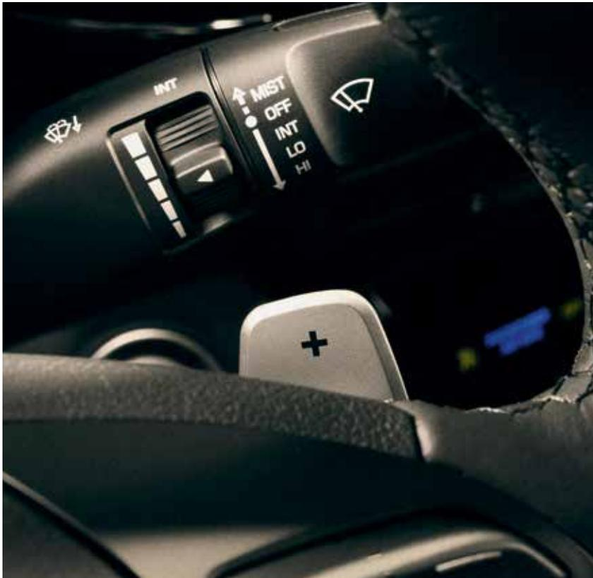
**Schaltwippen am Lenkrad.** Mit den am Lenkrad angebrachten Schaltwippen lassen sich die Rekuperationsstufen einfach und schnell verstellen, wenn Sie sich im Eco-Modus befinden. Im Sport-Modus können Sie über diese Schaltwippen manuell den Gang des 6-stufigen DCT Getriebes wechseln, um maximalen Fahrspaß zu erleben.
