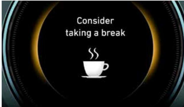
**Aufmerksamkeitsassistent.** Diese serienmäßige Funktion hebt Sicherheit und Komfort durch kontinuierliche Überwachung und Analyse des Fahrverhaltens auf ein völlig neues Niveau. Wenn ein Muster von Müdigkeit oder Ablenkung identifiziert wird, warnt der Aufmerksamkeitsassistent mit einem akustischen Alarm sowie mit einer Popup-Nachricht und schlägt dem Fahrer eine Pause vor.
